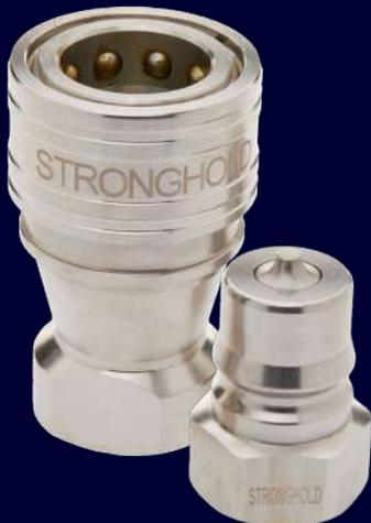
LES COUPLEURS RAPIDES INTÈGRENT UN **CLAPET ANTI-RETOUR** QUI SE FERME LORSQUE LA PRISE EST DÉTACHÉE DU COUPLEUR.
